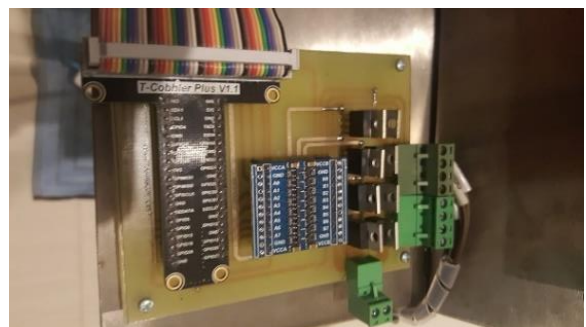
Gambar 7 Board logic converter yang terdiri dari power mosfet dan bidirectional converter
