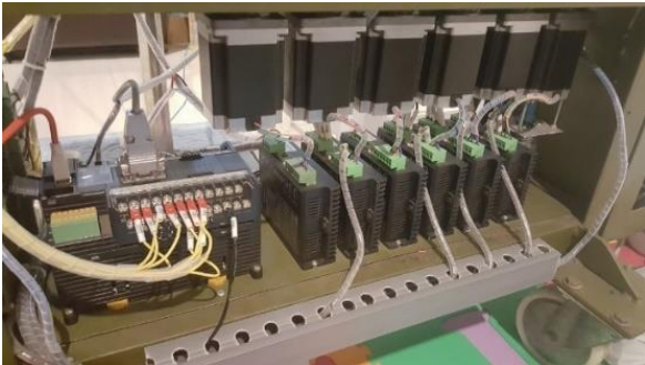
Gambar 2. Gambar susunan panel stepper motor dan controller daripada lengan robot
