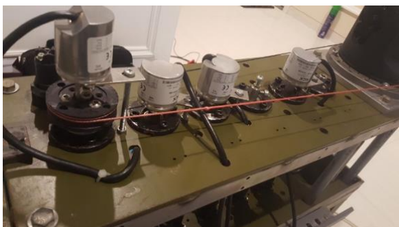
Gambar 3 Susunan incremental rotary encoder lengan robot
