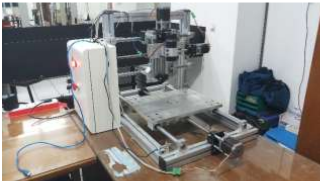
Gambar 5 Mesin CNC yang Sudah Dirangkai
