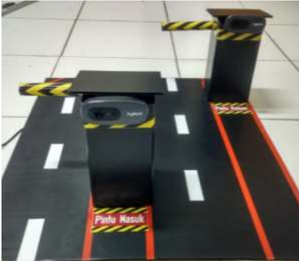
Gambar 2 Desain Miniatur Sistem Akses Parkir
