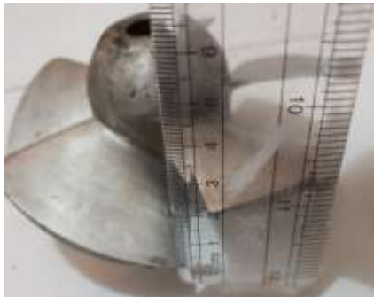
Gambar 10. Turbin yang memiliki jarak antar sudu 2 cm
