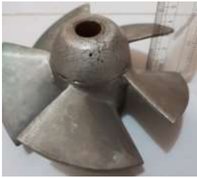
Gambar 9. Turbin yang memiliki jarak antar sudu 3 cm
