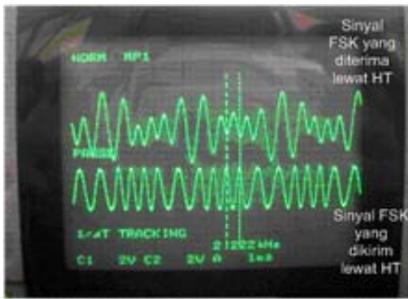
Gambar 10. Karakteristik Sinyal FSK Yang Dikirim Lewat HT
