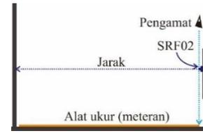
Gambar 12. Metode Pengujian Jarak Bacaan
