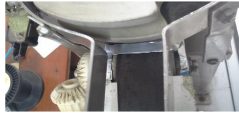
Gambar. 2. Sistem mekanis perpindahan dari conveyor in ke round table middle
