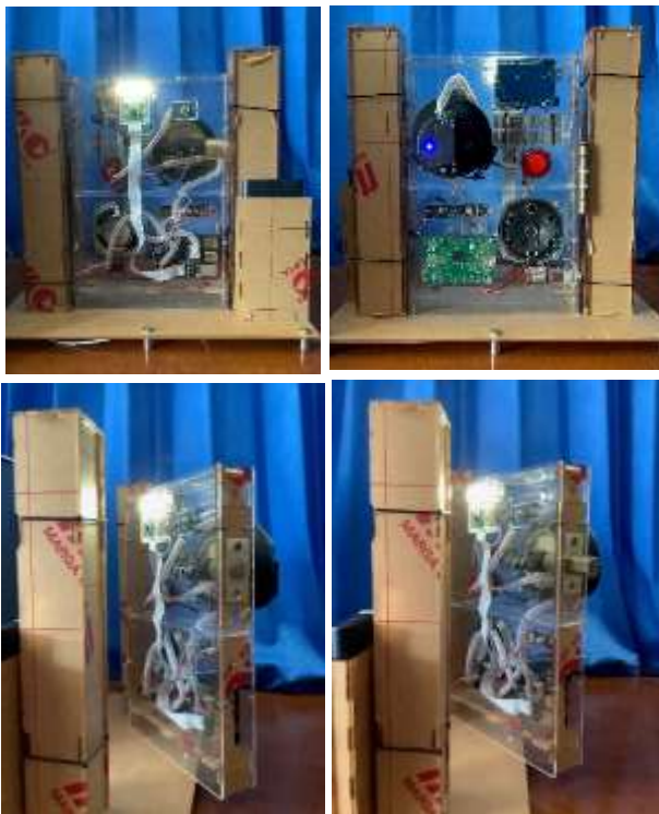
Gambar 6 Maket Smart Door yang Telah Dirakit
