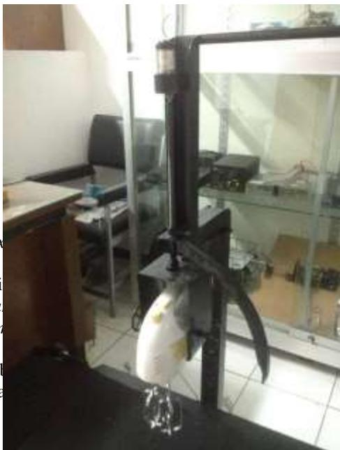
Mixer ini adalah sudah dimodifikasi terbuat dari bahan stainless steel dan aluminium (gambar 10). Untuk penempatan mixer ini sudah terpasang di bagian bawah tempat penempatan minuman.
