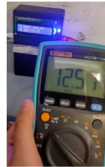
Gambar 12 Pengujian sensor tegangan solar panel di SMP Kristen Petra 2
