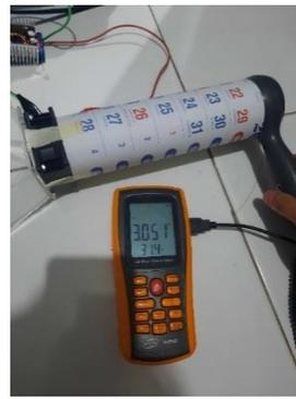
Gambar 9. Pengukuran Kecepatan Fan Penghisap Menggunakan *Anemometer*
