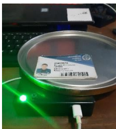
Gambar 17 Pembacaan Tag Dengan Penghalang Logam
