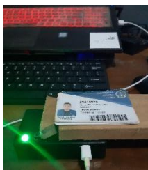
Gambar 16 Pembacaan Tag Dengan Penghalang Kayu
