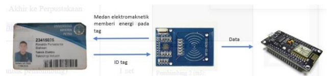
Gambar 4 Komunikasi RFID Dengan Mikrokontroler
