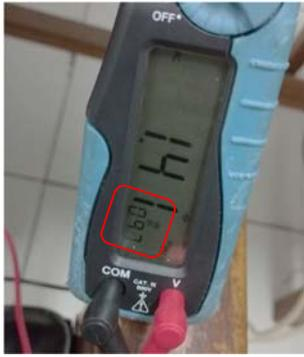
Gambar 19. Faktor Daya Pada Kompor Induksi Saat Daya Maksimal.
