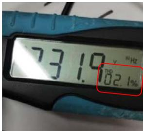
Gambar 20. THDv pada Kompor Induksi.
