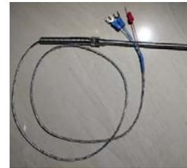
Gambar 4. Sensor RTD PT100 3 Wires.
