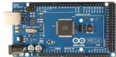
Gambar 6. Arduino Mega.
