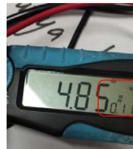
Gambar 18. Faktor Daya Pada Kompor Induksi Saat Daya Minimal.
