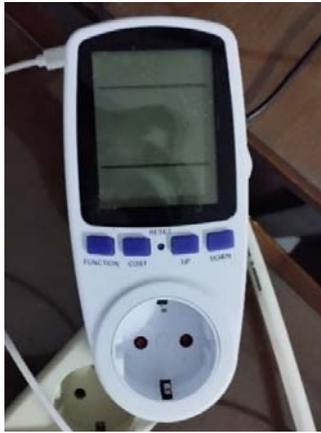
Gambar 13. Power Meter Untuk Mengukur Penggunaan Listrik
