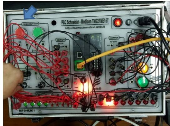
Gambar 9. Pengujian Potensiometer Pada PLC
