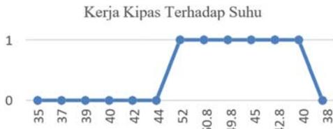
Gambar 22. Grafik Kerja Sistem Otomatis Mengendalikan Kipas
