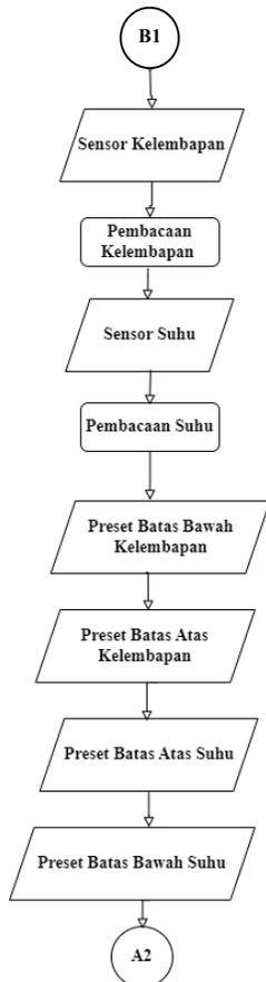
Gambar 16. Flowchart Kerja Pompa Misting Pada Mode Otomatis
