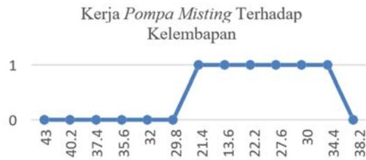
Gambar 26. Grafik Kerja Sistem Otomatis Mengendalikan Pompa Misting Berdasarkan Kelembapan
