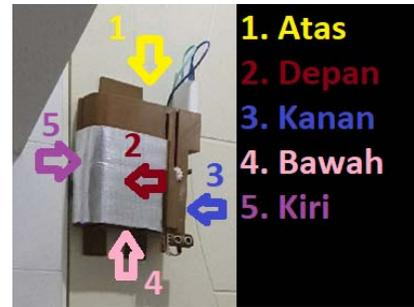
Gambar 6. Posisi Pengukuran Intensitas UVC di Luar Alat
