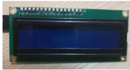
Gambar 7. Modul LCD 16x2
