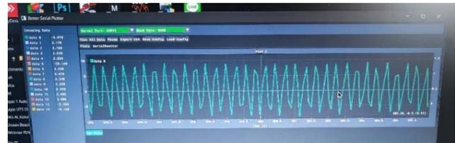
Gambar 9. Hasil Pembacaan Gelombang dengan Menggunakan Rangkaian Pembagi Tegangan
